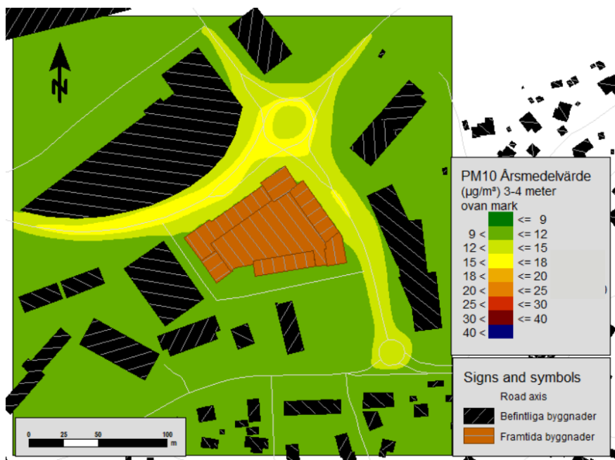
Figur 17 Årsmedelvärdet av PM10 för beräkningshöjd 3–4 m. MKN 2030 20 respektive MKM 15 \mu\text{g}/\text{m}^3 , befintlig MKN 40 \mu\text{g}/\text{m}^3 .
