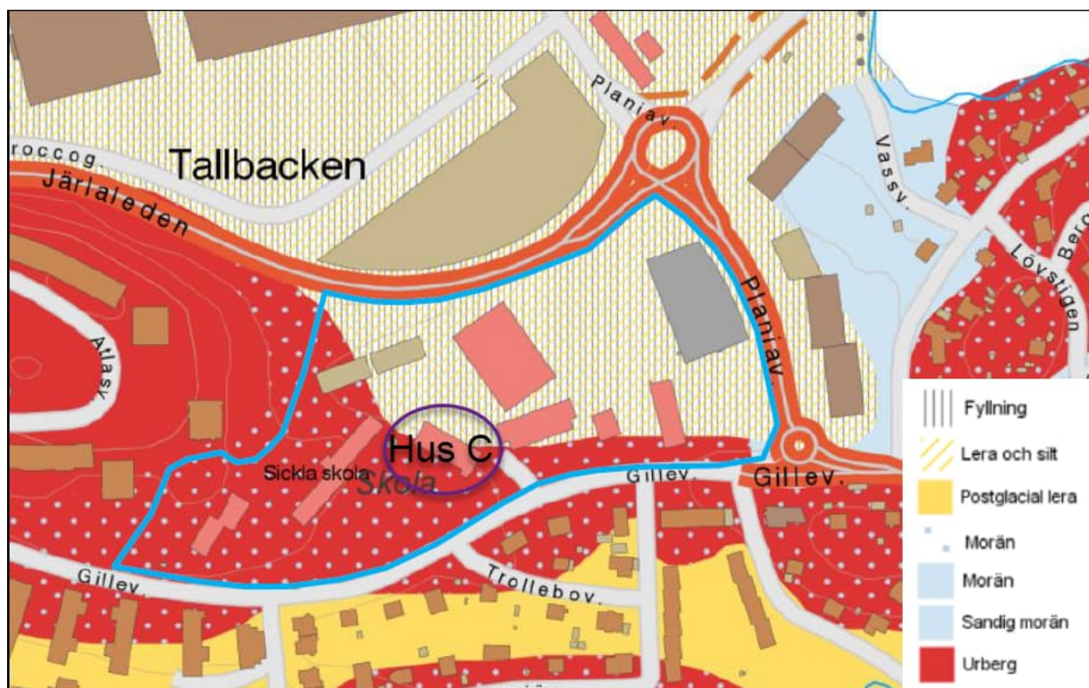
Figur 3: Sickla skola ligger delvis på tunna moränlager på berg, delvis inom utfyllt område med lera och fyllnadsmaterial.
