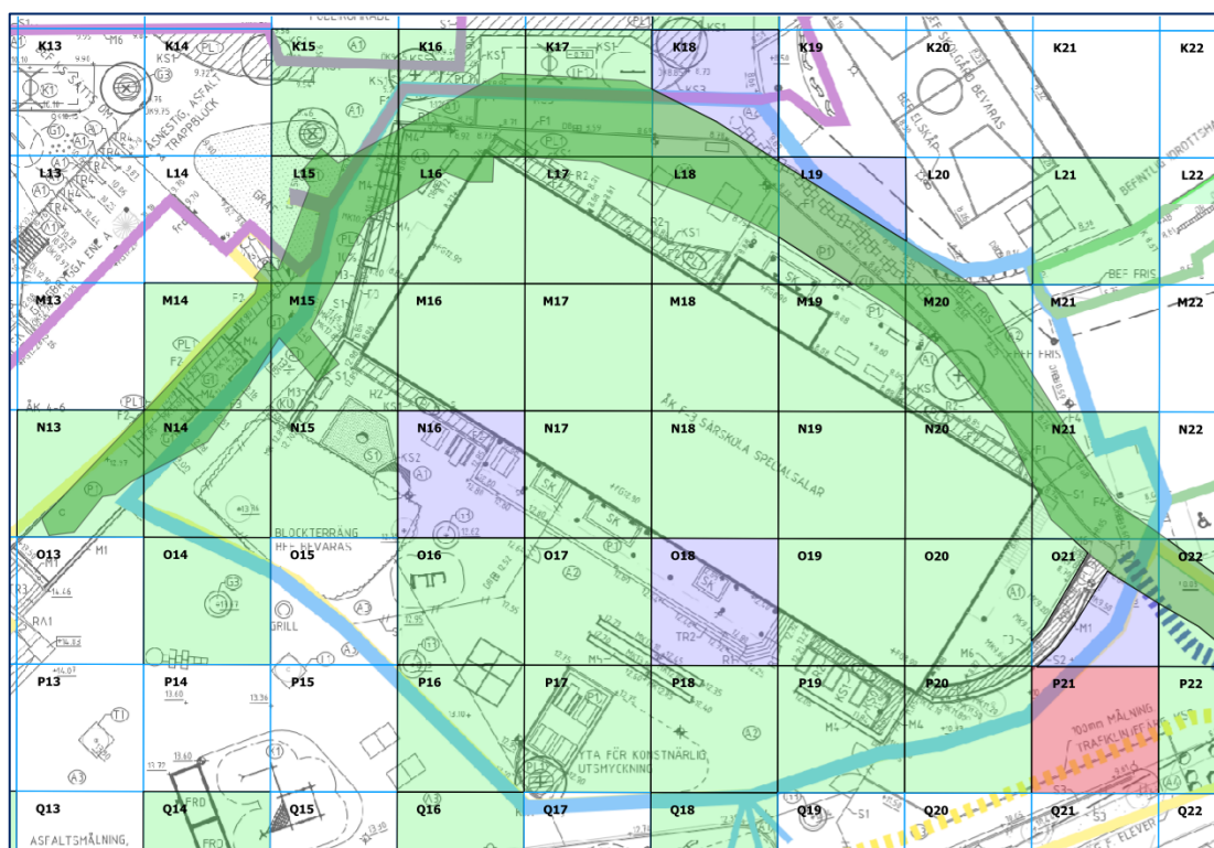
Figur 5. Översikt av rutorna och kvarlämnade föroreningar. Gröna rutor har ämnesshalter under PSRV medan violetta rutor har något eller några ämnen som överskrider PSRV för marktypen. Det mörkgröna området visar ledningsgravens utsträckning, med tillfört inköpt material till 2-2,5 m. Röd färg innebär klassning över FA (rutan är utanför del-entreprenaden och redovisas i kommande skrivelser).
