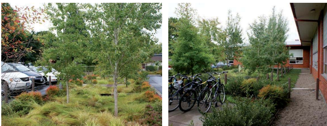
Figur 10. Exempel på utformning av regngårdar i Portland.
