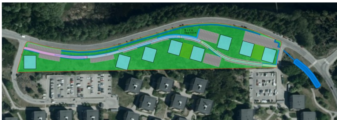
Figur 9. Svackdiken (i blått) längs den föreslagna vägen fördröjer 105 m 3 vilket är något högre än åtgärdsnivån 10 mm (73,5 m 3 ) vid fördröjning av hårdgjorda ytor inom planområdet. Pilarna visar flödesriktning på det ytavrinnande vattnet.
