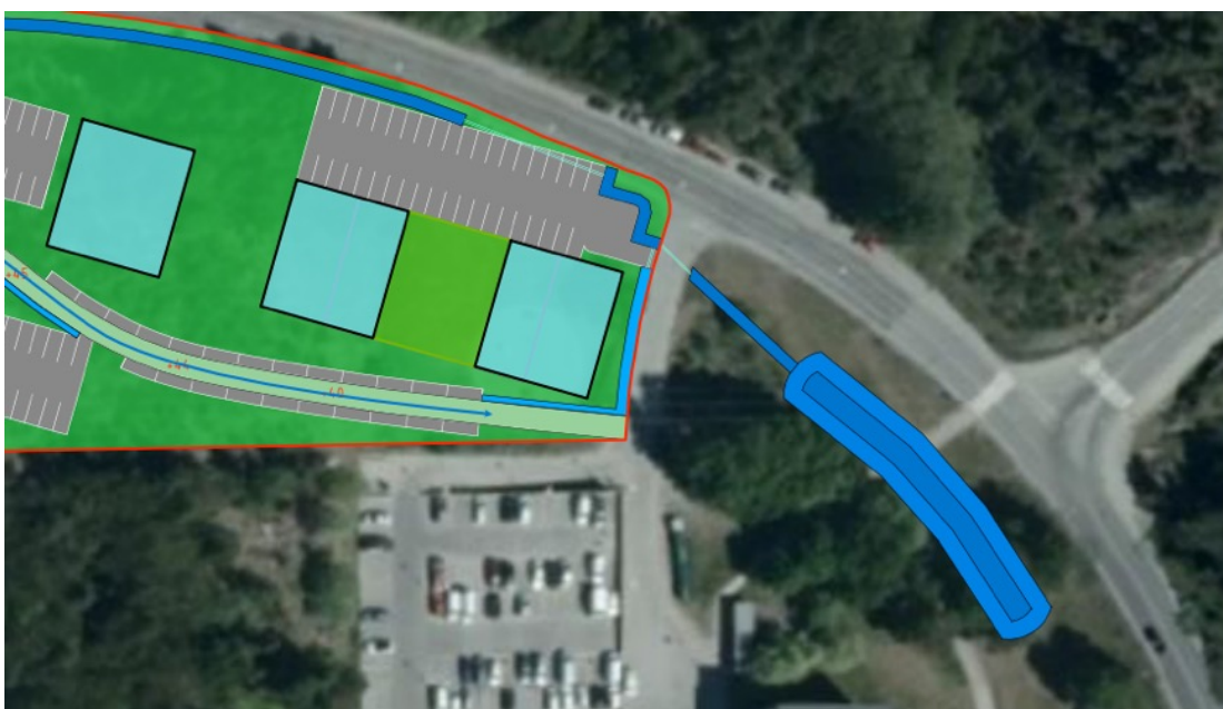
Figur 10. Våtdamm och anslutande svackdike för fördröjning och rening av resterande volym som ej kan fördröjas inom planområdet (i rött). Svackdiket (bredd 2m, djup 0,5 m) längs Skarpövägen är dimensionerat med en flödeskapacitet för att kunna hantera ett dimensionerande flöde vid ett 100-årsregn med regnvaraktighet 12 minuter. Svackdiket kan teoretiskt fördröja en volym på cirka 670 m 3 , men huvudsyftet är inte fördröjning utan avledning av större dimensionerande flöden till våtdammen.
