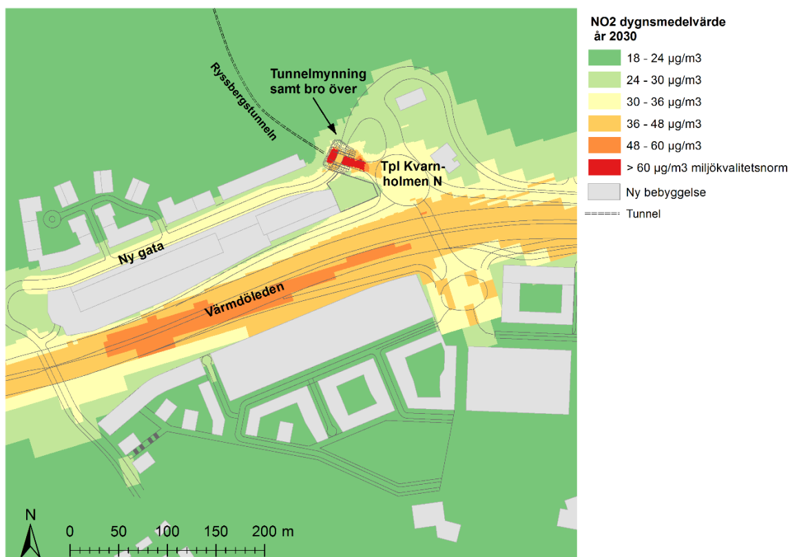
Figur 7. Beräknad dygnsmedelhalt av kvävedioxid, NO 2 (µg/m 3 ) under det 8:e värsta dygnet år 2030. Överskrider halten på kartan 60 µg/m 3 överskrider miljökvalitetsnormen. Miljömål för dygnsmedelhalt saknas.
