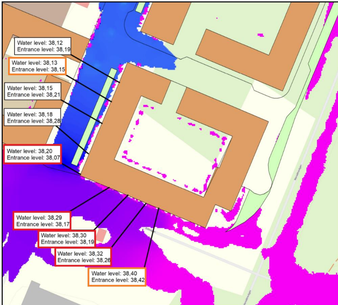
Figur 5. Jämförelse mellan nivå på entré och maximal översvämningsnivå. Svart ruta betyder att entrén ligger minst 5 cm över maximal översvämningsnivå, orange ruta betyder att entré ligger 0-5 cm över maximal översvämningsnivå, röd ruta betyder att entré ligger under maximal översvämningsnivå.
