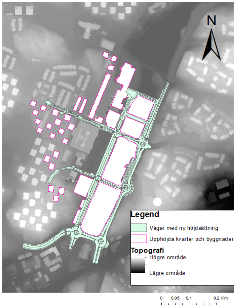
Figur 7. Karta visande topografi, vägar inkluderade i den nya höjdsättningen, samt kvarter och byggnader vilka höjts upp ur topografin för att generera så korrekta flödesvägar som möjligt.
