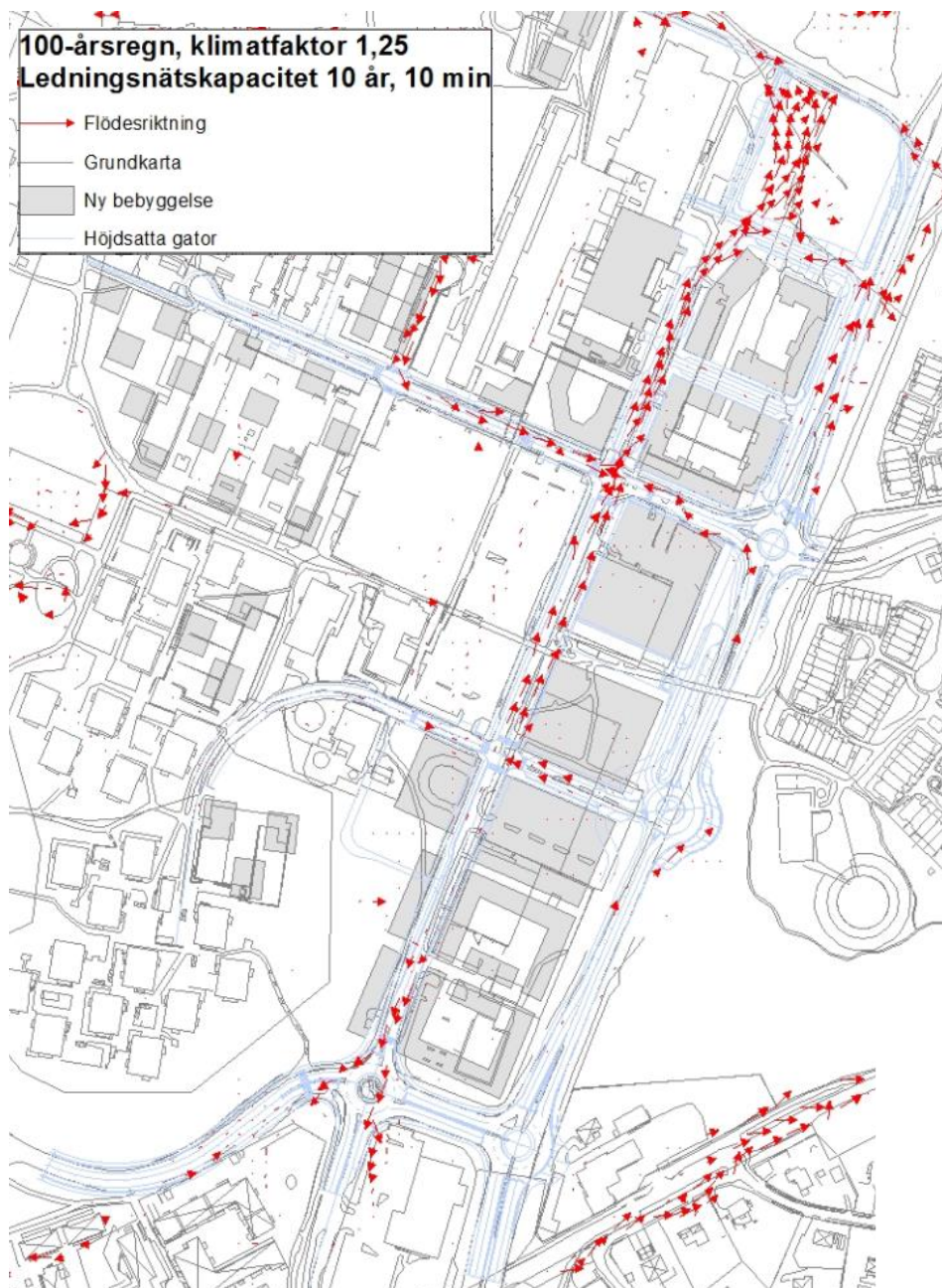
Figur 14. Beräknade flödesriktningar och flödes hastigheter för det scenario där ett ledningsnät dimensionerat för ett 10-års regn med 10 min varaktighet är bortdraget från 100-årsregnet(Bilaga 4).
