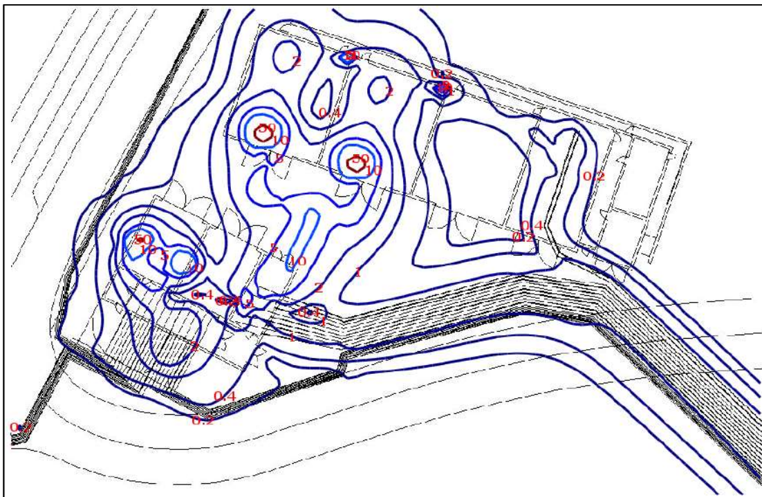
Magnetfält vid årsmedellast. Kurvan för 0,4 är närmare stationerna än vid maxlast. Högre värden finns inom stationsområdet. Rakt över ledningspaketet är 1 \mu\text{T} beräknad som sedan avklingar till 0,4-0,2 ganska snabbt.
