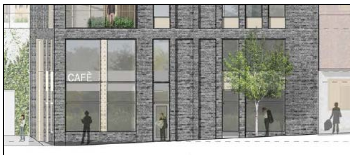
Fasad mot Värmdövägen som ges en sockelmarkering i två våningar.
