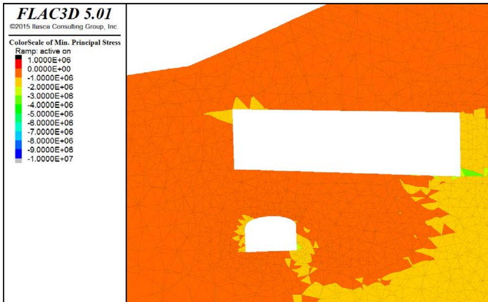
Figur 23: Minimal principal stress för Snitt 3, gravitativt spänningsfält.
