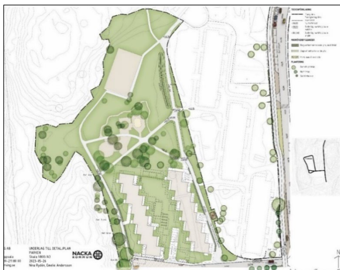
Figur 10: Utformning av delar av Oxelvägen, parken och den nya lokalgatan. Centralt i bilden syns de veckade fasaderna i det norra kvarteret. Näststationen som syns i brunt längst ner i bilden har placerats på en plats närmare lokalgatan. (Förstudie, Bjerking 2023)
