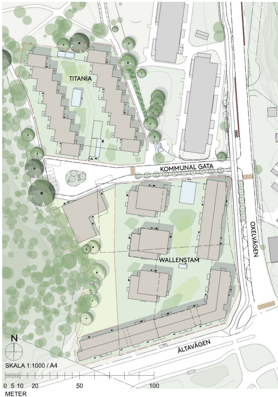
Figur 5: Situationsplan som redovisar den nya bebyggelsen, föreslagna nya byggnader i beigebrun, befintliga byggnader i grått. Det norra kvarteret ska uppföras av Titania och det södra av Wallenstam. Skala 1:1000/A4 (ÅWL Arkitekter 2024)
