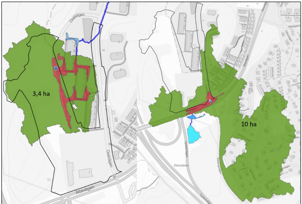
Figur 4-6. Tillrinningsområden (gröna ytor) för lokala lågpunkter (röda ytor) i befintlig situation vid 50 mm regn. Bild: Scalgo Live (Scalgo, u.d.)
