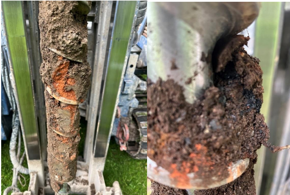
Figur 5-1. Bilder på skruvborrsprover med tegel samt svart missfärgning (högra bilden). Från höger, prov 24RE16 0,5-1 m och till vänster 24RE10 0-0,5 m.
