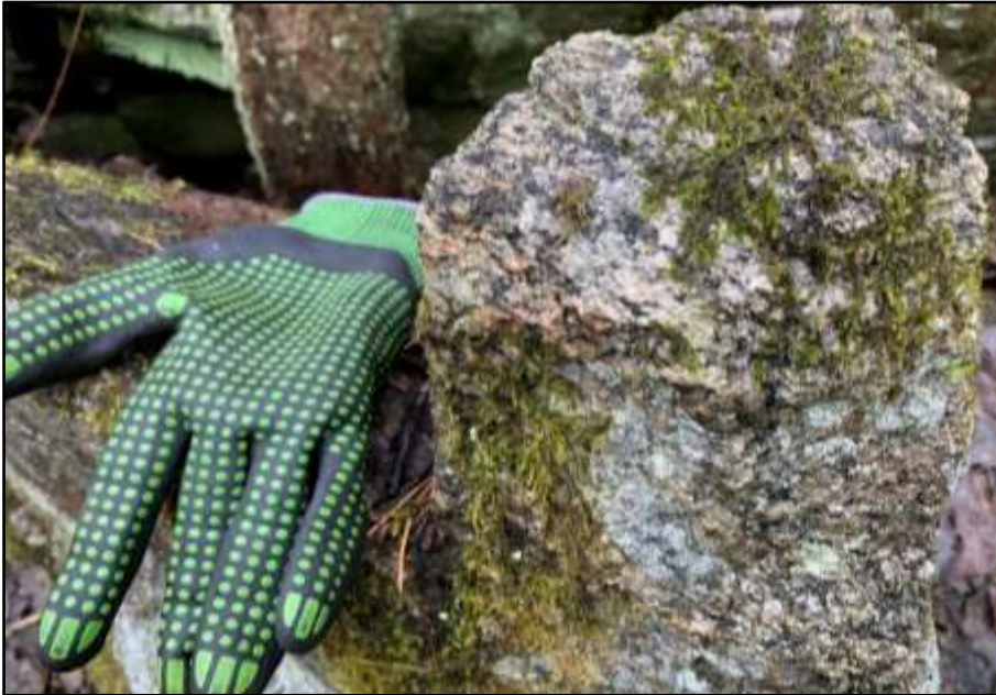
Figur 4. Närbild på från berghällen och losshällen sten (med geologhammare), grovkristallin kalifältspat kan urskiljas.
