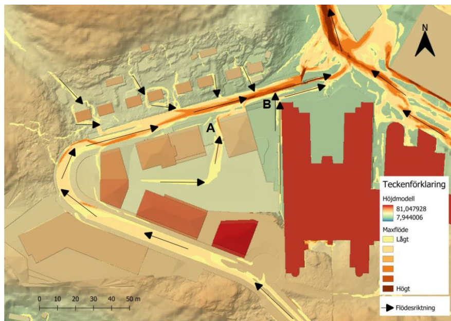
Figur 24 Bilden visar maxflöde, 100-årsregn, 6 timmars varaktighet, klimatfaktor 1,4. Resultatet redovisar en framtida situation. Bild: Sweco, 2026
