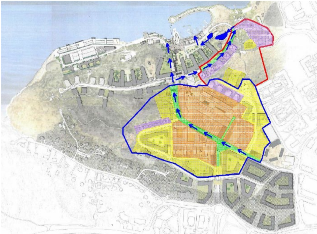
Figur 23 Delavrinningsområde 1 (blå), delavrinningsområde 2 (röd) samt markanvändningarna handel och kontor (orange), nya flerbostäder med LOD (gul), befintliga flerbostäder utan LOD (lila) och vägar (grön). Naturmark inom delavrinningsområdena är oskrifferad. Dagvattnets flödesvägar är markerade med blå pilar. Den planerade dagvattendammens läge är markerat med blå färg. Karta: Sweco, 2015
