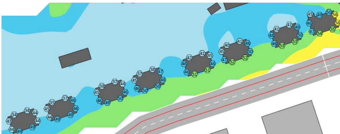
Figur 21 Bilden visar arbetarbostäderna i Brf Tändkulan och ekvivalent ljudnivå från trafik, planalternativ med vändplan, utan nedfart till Torggaraget. Bild: ACAD, 2026.
