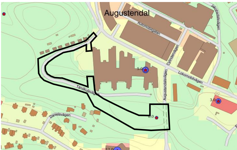
Figur 3. SGUs jorddjupskarta över skede 2a, det aktuella undersökningsområdet är markerat med svart. Grön indikerar jorddjup mindre än 1 m. Ljusgrön indikerar jorddjup 1 – 3 m. Gul indikerar jorddjup 3 – 5 m.
