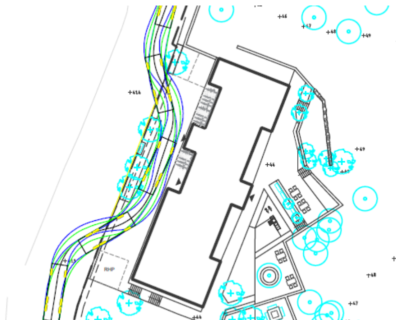
Figur 3-6 Körspår som visar att angöring för sopbil vid hus 2 fungerar med en 20 meter lång hållplats.
