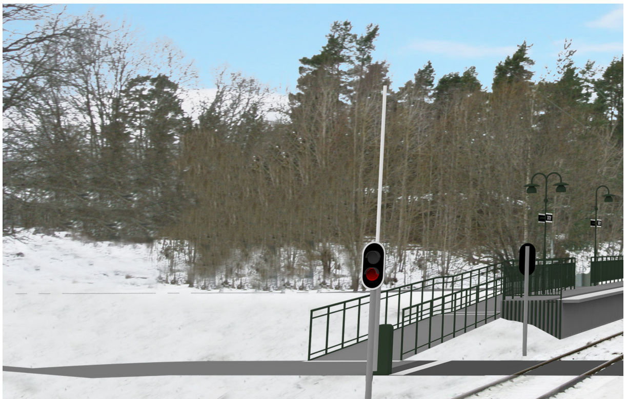
Exempel på "rampanslutning i mark"
