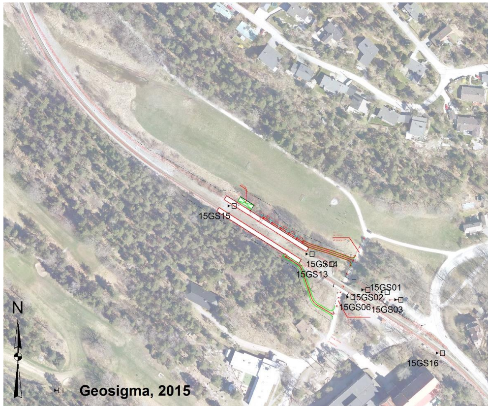
Figur 3. Provtagningspunkter från tidigare utförd miljöteknisk markundersökning (Geosigma, 2015)
