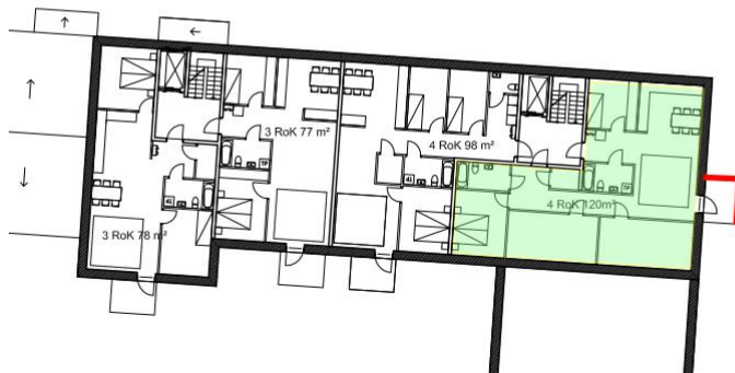
Figur 8. Balkonginglasningar för att uppfylla riktvärdena för ljudmiljö på balkonger. Balkongen för den grönmarkerade lägenheten uppfyller inte kravet om en maximala ljudnivå om högst 70 dBA på balkongen trots inglansningen. Riktvärdet avseende den ekvivalenta ljudnivån (55 dBA) bedöms kunna uppfyllas.
