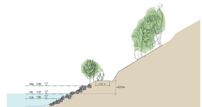
Sektionen 1A-1A visar promenadstråket västerut som placeras på den hylla där befintlig stig idag ligger. Stigen breddas och förbättras.
