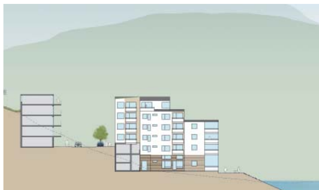
Sektion 5A-5A genom Utsiktsgatan visar Strandhusens placering i den branta terrängen, med entréer på två nivåer, från gård och gata.
