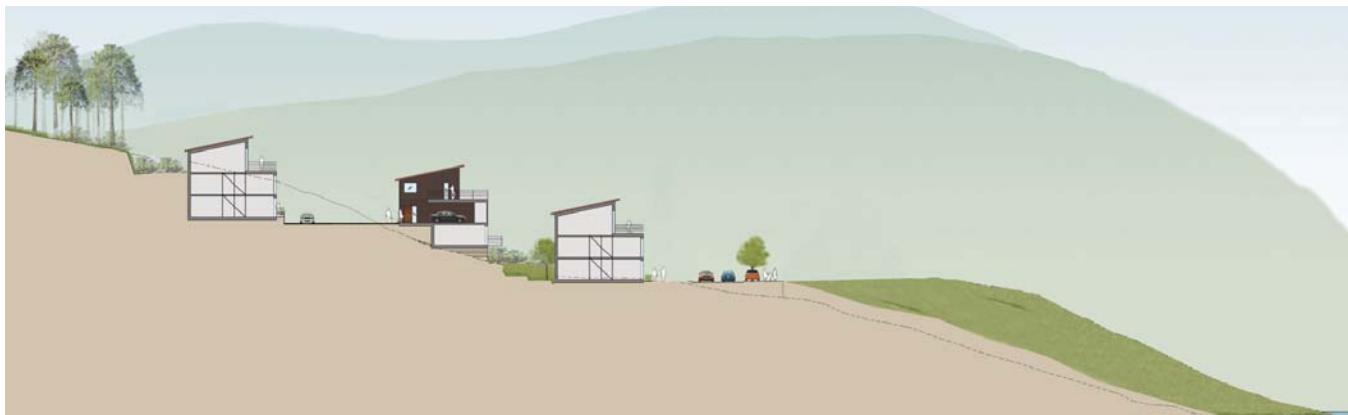
Sektion 6B-6B genom Utsiktsgatan. Husen tar upp höjdskillnaderna med souterräng. Befintlig marknivå illustreras med streckad linje.
