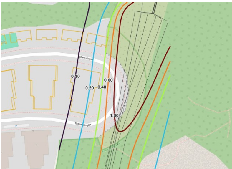
Figur 18: Magnetfält Tollareslingan på höjden +30 meter, årsmedelvärde för T (mikrotesla). Ljusgrön linje visar 0,4 \mu\text{T} . (Energiteknik AB, 2025)
