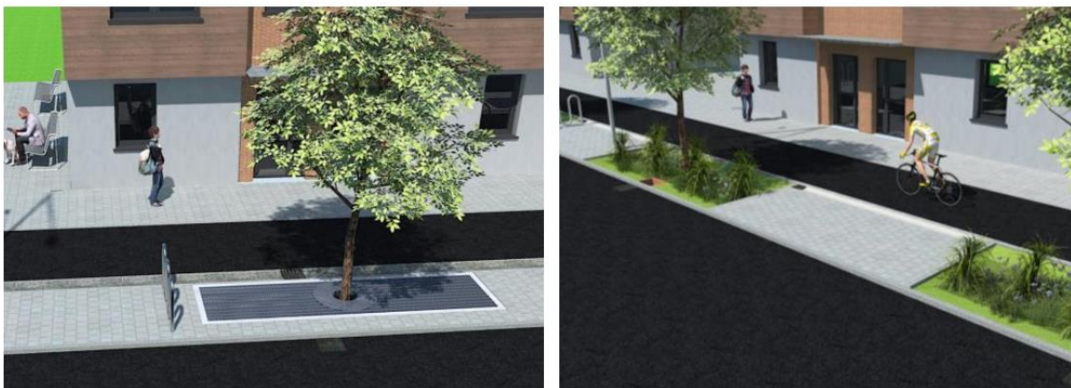
Figur 28. Täckt respektive öppen nedsänkt regnväxtbädd med träd. Nacka kommun, 2022.
