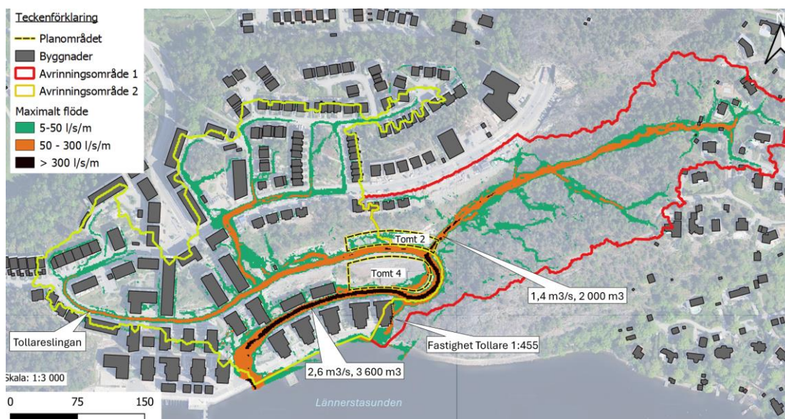
Figur 20a. Resultat från skyfallsmodelleringen, befintligt scenariot. Maximala flöden över 5 l/s/m inom avrinningsområdena 1 och 2.
