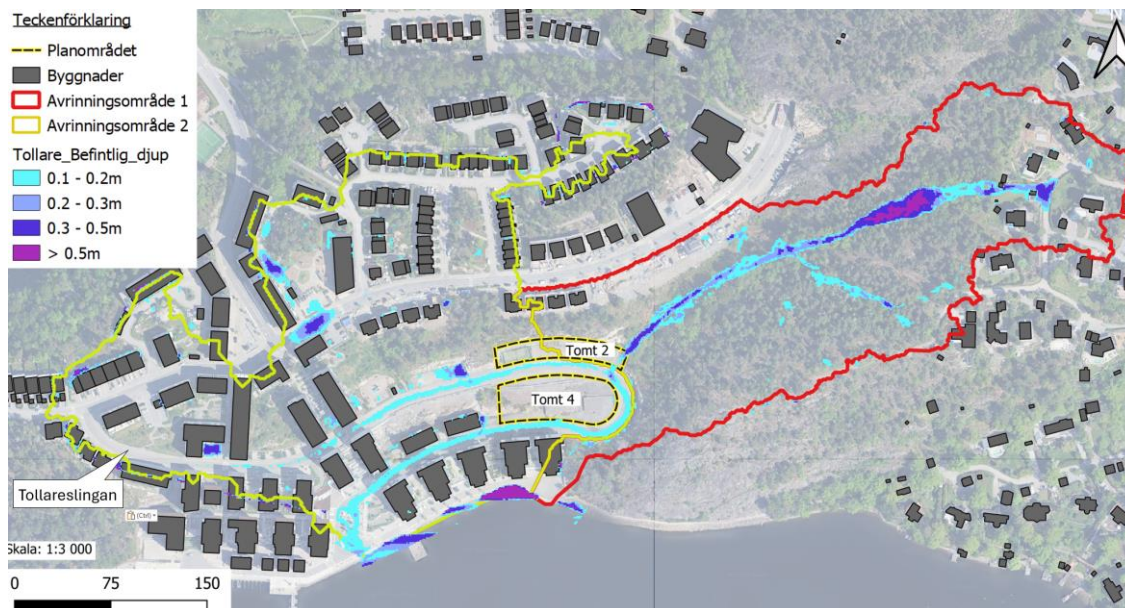
Figur 21. Resultat från skyfallsmodelleringen, befintligt scenariot. Maximala vattendjup över 10 cm i meter redovisas. Vattendjup i recipienten ska inte tolkas då vattendjupet uppstår av modelltekniska skäl.
