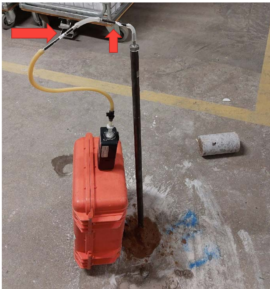
Figur 8. Provtagning av porluft i grund sond. De röda pilarna pekar mot adsorbentrören.
