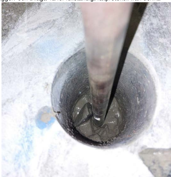
Figur 5. Hål i betongplatta och underliggande lager av sandig makadam. Fuktigheten bedöms härröra från kylvattnet som användes i samband med betonghåltagning. Metallröret som stuckits ned i hålet är sonden som användes vid porluftprovtagning.
