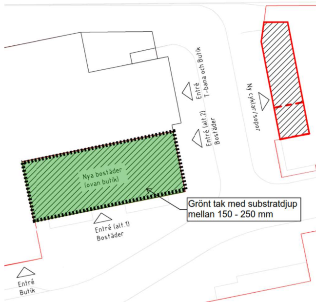
Illustrationsplan som redovisar en dagvattenlösning med grönt tak. Konceptillustration.
