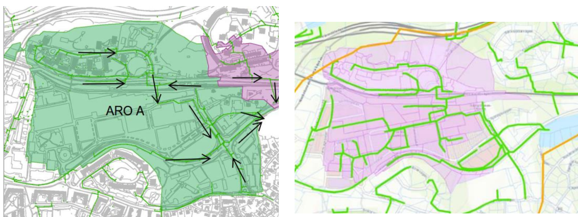
Figur 4. Det tekniska delavrinningsområdet där Tryckluftsfabriken är beläget i är markerat i grönt i vänstra bilden, "ARO A". I den högra bilden är det befintliga dagvattenledningsnätet tydliggjort. (Bilder inhämtade ur fördjupad VA-utredning, Sweco 2017).
