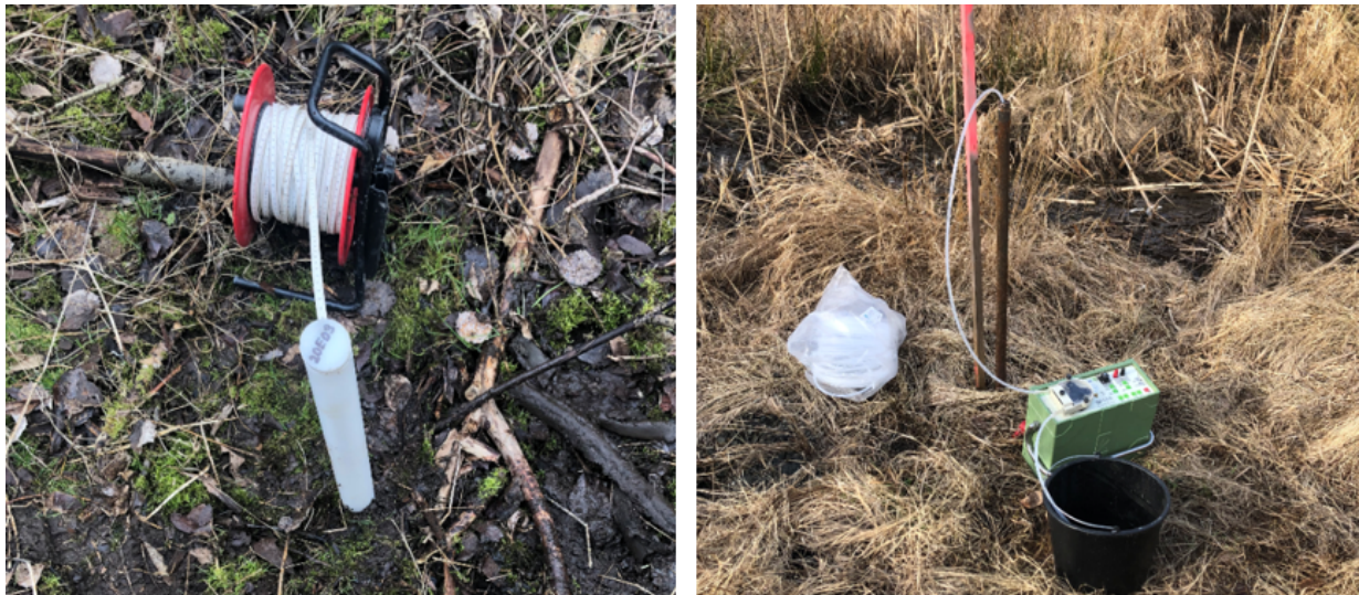
Figur 3. Nivåmätning och omsättningspumpning.
