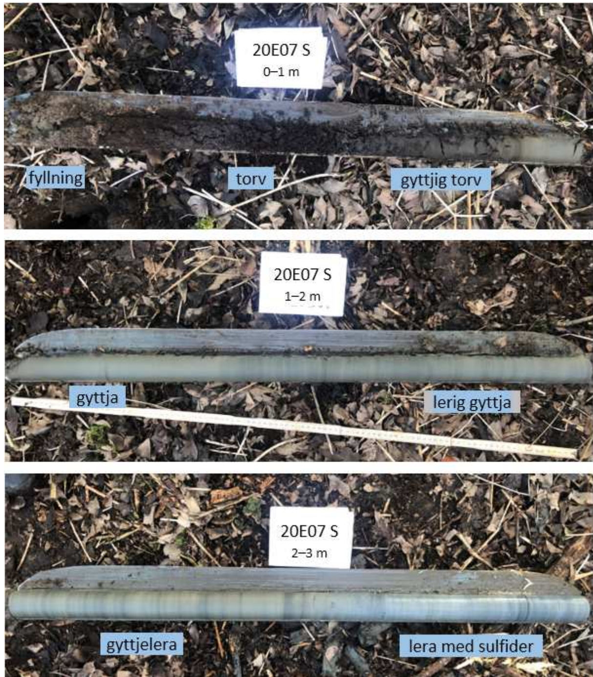
Figur 4. Exempel på prov av jordlager 0 till 3 meters djup. Prover tagna med rysskannborr.
