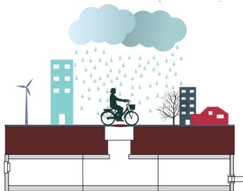
Figur 9. Rörmagasin för fördröjning av dagvatten kan till exempel byggas under parkeringsytor eller andra trafikerade ytor. För rening av dagvatten förhöjs magasinets utlopp något.
