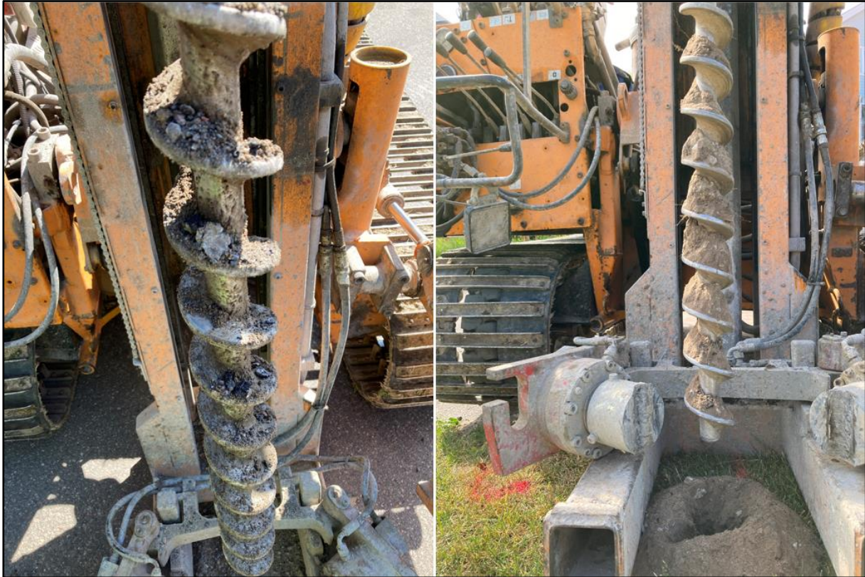
Figur 5-1 Skruvprovtagning. Vänster: 21GS01 (3-4 m). Grov fyllning. Höger: 21GS02 (0-0,5m), finkornigare fyllning.
