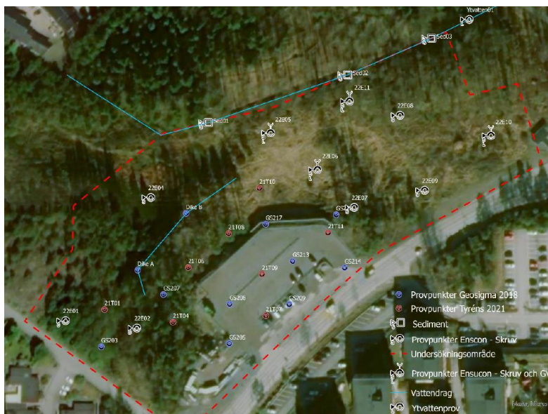
Figur 20 - Samtliga provpunkter från Geosigas, Tyréns och Ensucons undersökningar.
