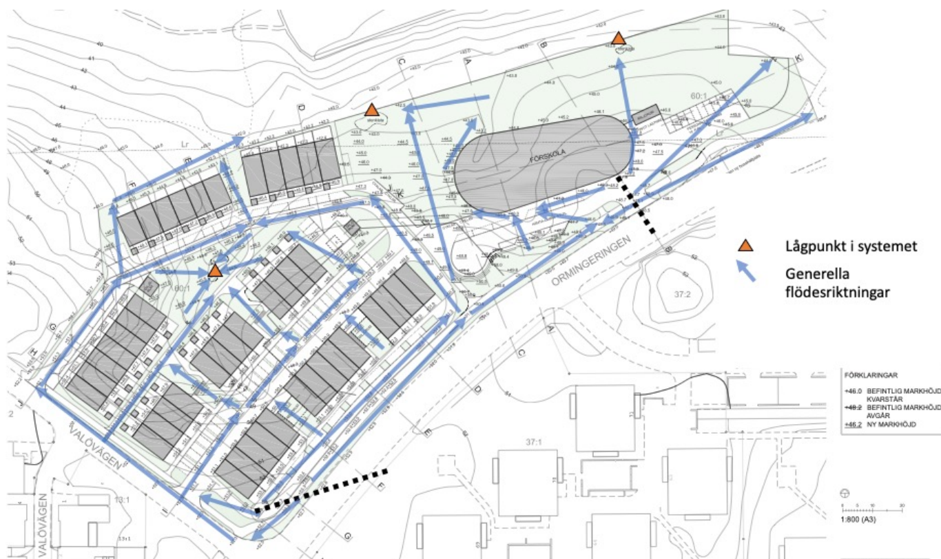
Figur 13. Planområdets generella flödesriktningar. Svart streckad linje anger respektive delområdes högsta punkt och där framtida markyta kommer fungera som små lokala vattendelare inom delområdena.
