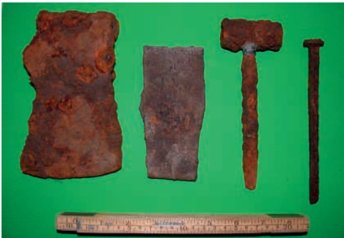
Ett urval av de verktyg, som påträffades från tremänningarnas bygge av timmerskansarna. Fr.v.: yxblad, järnkil, borr och järnspik.
