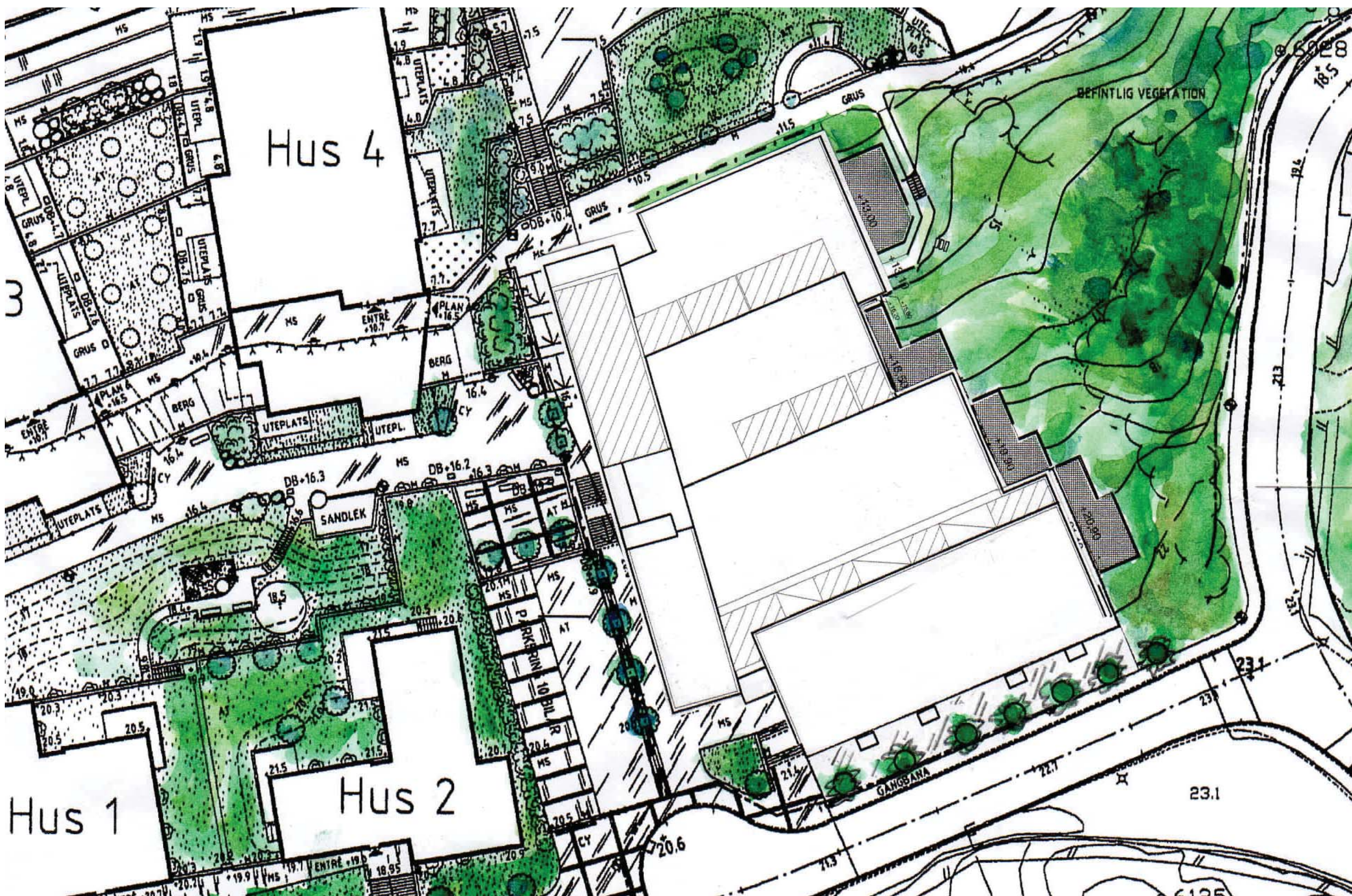
Illustrationsplan med nya uteplatser längs den östra fasaden och nya entréer utmed Östra Finnbodavägen. En ny gångväg förläggs mellan den östra entrén och gångvägen söder därom.
