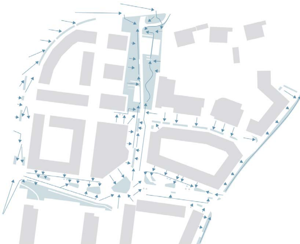
Schematisk diagram som visar dagvattenhanteringen på allmän plats. Bild: SWMS arkitektur.
