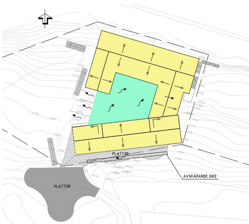
Figur 11. Framtida avrinning. Gult område visar planerade och befintliga takytor och grönt område planerad innergård.
