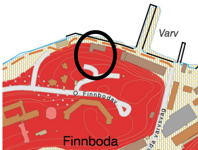
Figur 3. Jordartskarta, SGU 2016. Skrafferat område består av fyllning på postglacial lera och rött område av urberg. Utredningsområdet omringas med svart linje.
