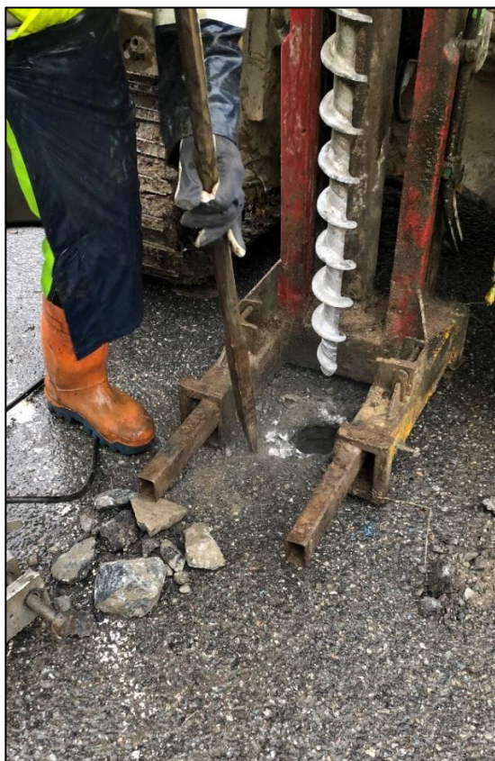
Figur 10 Krossmaterial i provpunkt 20GS01
