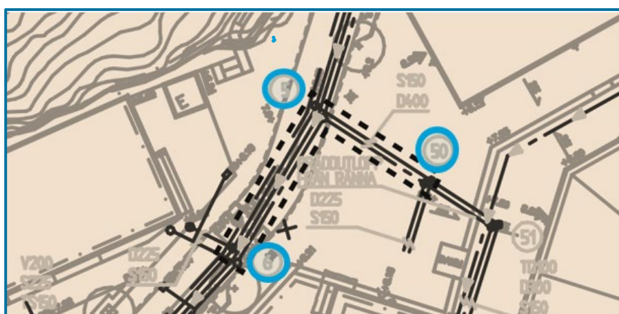
Figur 14 Detalj ur figur 13. Strömningsavskärande fyllning finns inom område med svart streckning för att hindra grundvattensänkning i södra delen av Finnbodaområdet.
