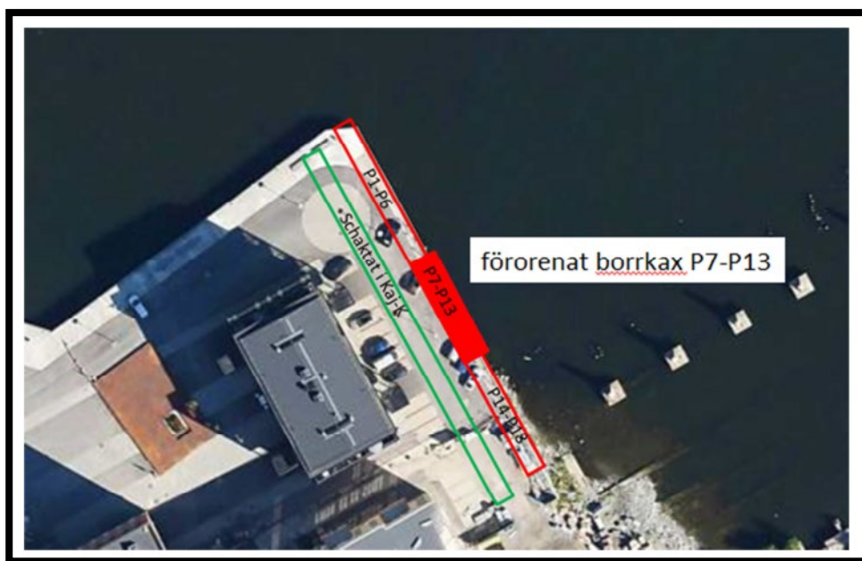
Figur 8. Kaj-K där schaktområdet markerats med rött för tjära noterats under pålning (P7-P13).
