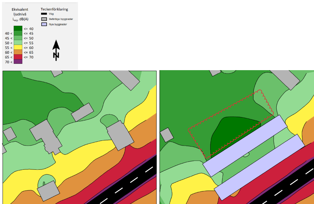
Figur 10. Den vänstra bilden visar beräknad befintlig bullersituation (ekvivalent ljudnivå) för fastigheterna Björknäs 1:360 och 1:376. Den högra bilden visar beräknad bullersituation (ekvivalent ljudnivå) för samma fastigheter vid utbyggnad enligt alternativ 2. Röd markering visar område för möjlig uteplats.
