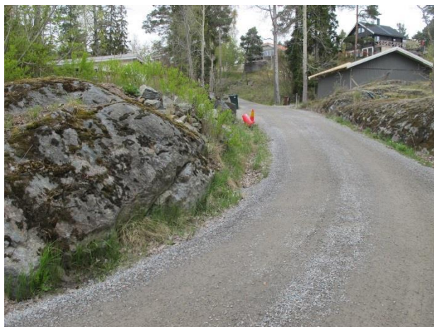
Bild 21 Kurva på Vinkelvägen som behöver breddas. Bergknallen till vänster sprängs ut och vägen anpassas så att hällen till höger bevaras.
