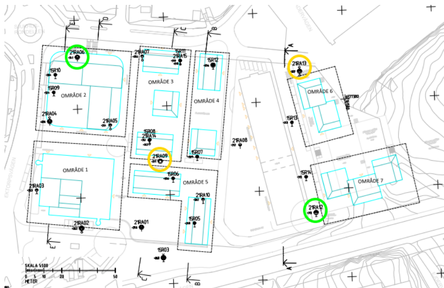
Figur 40: Provtagningspunkter (gult/grönt) utförda inom miljöundersökningen, 2021. Provtagningspunkter i gult överskrider riktvärdet för KM, provtagningspunkter i grönt underskrider KM.
