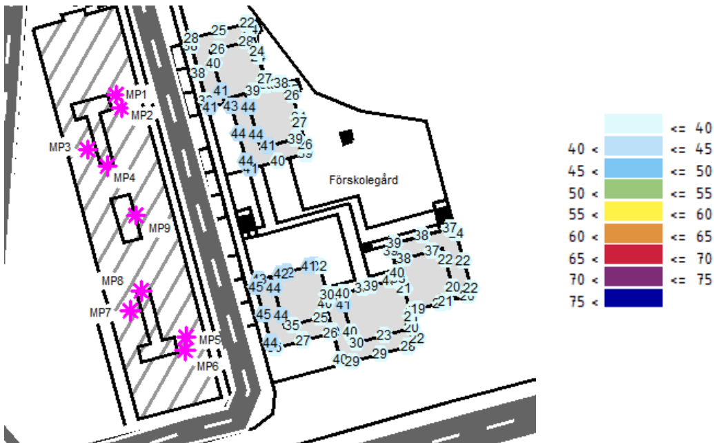
Figur 12. Ekvivalenta ljudnivåer med åtgärdade takfläktar
