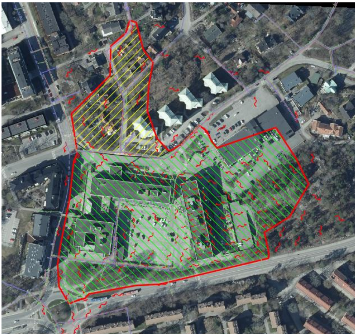
Figur 8. Det naturliga avrinningsområdet markeras med röd linje och det tekniska med skrafferad gul och grön yta. Bildkälla: Google Earth.
