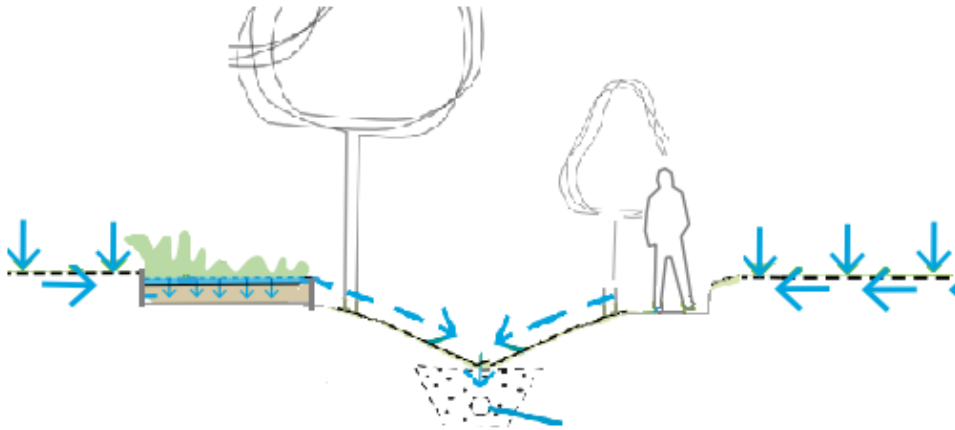
Figur 31. Principlösning för kombinerad dagvatten- och skyfallshantering där en växtbädd kan brädda ut i en översvämningsszon. Skissen är en mycket modifierad version av principskisserna i Riktlinjer för kvartersmark i tät stadsbebyggelse (Stockholm stad, 2017).
