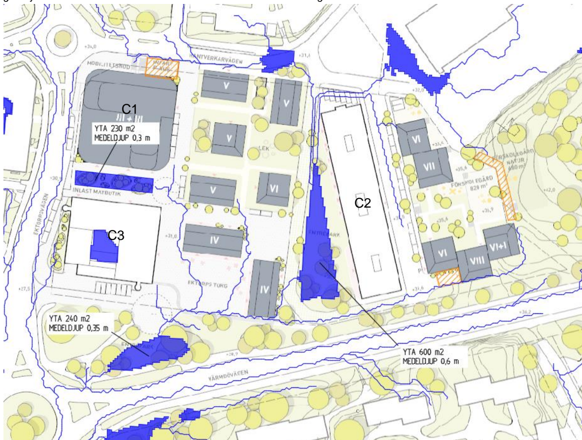
Figur 26. Simulering i Scalgo Live av föreslagen ny höjdsättning av marken. Blåa områden visar var vatten samlas vid ett klimatanpassat 100-års regn och blåa linjer visar flödesvägar. Riskområden vid garagedrifter och vid förskolan markeras som orangea områden.
