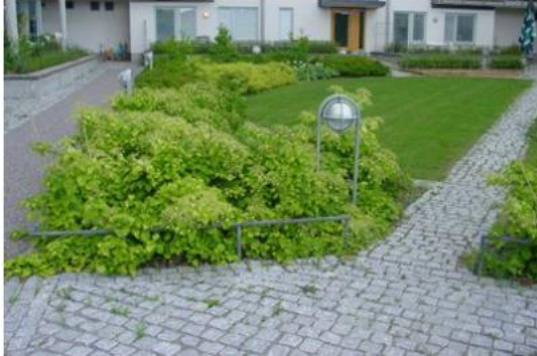
Figur 12. Exempel på permeabla beläggningar i form av grus/sand och små gatstenar. Källa Sweco
