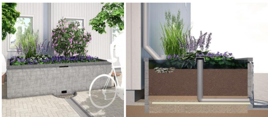
Figur 12. Upphöjd växtbädd i anslutning till byggnad (Bildkälla: Tengbomgruppen) samt prinsipskiss för upphöjd biofilterkonstruktion (Vinnova 2014).
