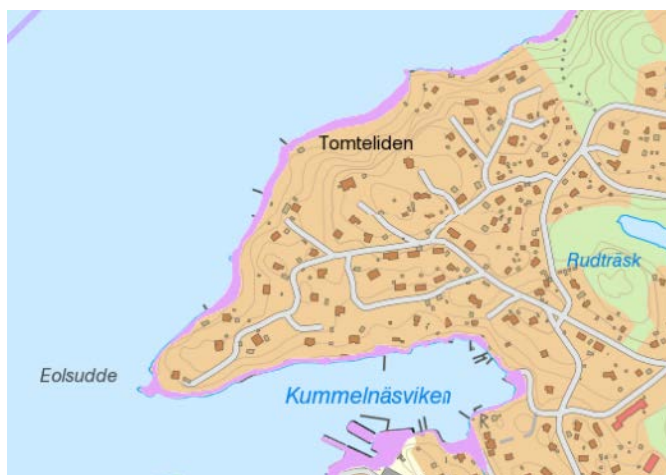
Rekommenderad lägsta grundläggningsnivå pga höjda havsnivåer år 2100
