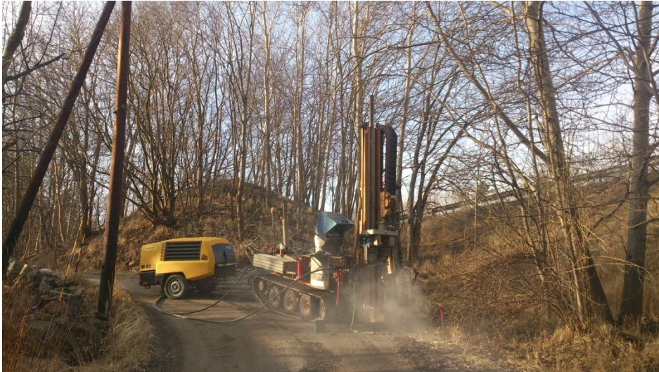
Jordbergsondering i undersökningspunkt SMS106
