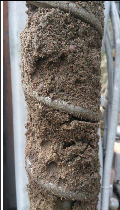
Skruvprovtagning i fyllning i undersökningspunkt SMS130
