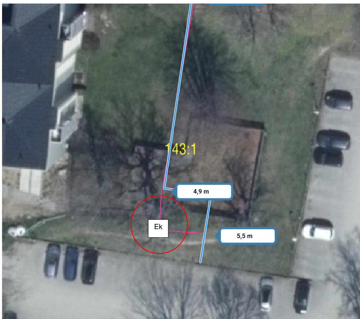
Bild 2. Uppskattad gräns till område för arbetsområde vid grundläggningsarbeten intill eken.
