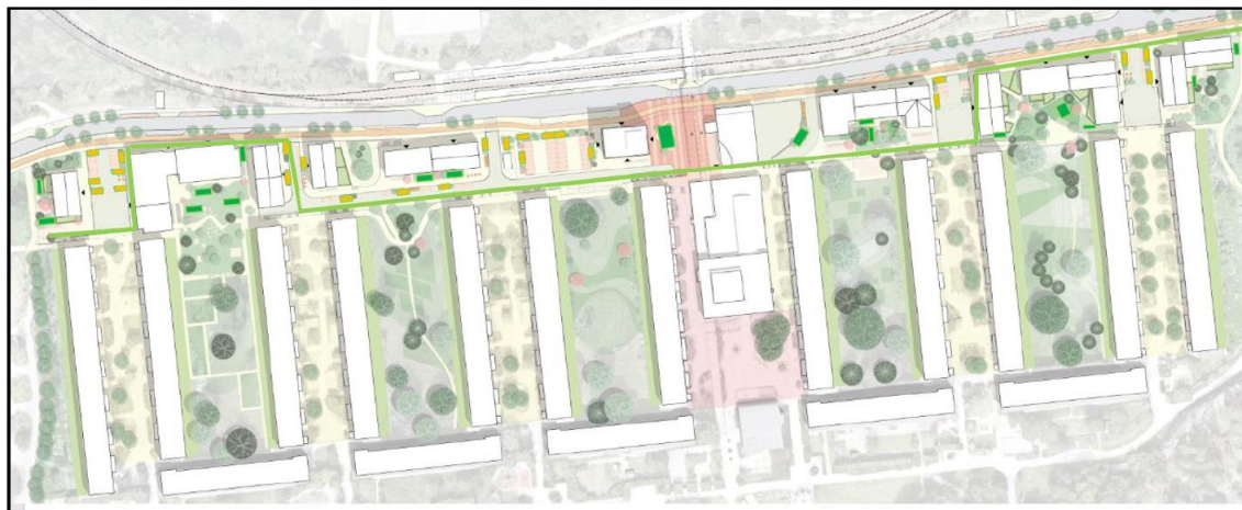
Figur 1. Skiss över var dagvattenlösningar i form av regnbädd (grön) och växtbädd (gul) kan placeras. Dagvattenledningen planeras längs den gröna linjen
