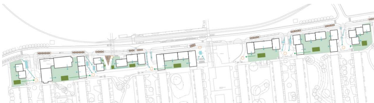
Figur 1. Principskiss med ungefärliga placeringar av föreslagen dagvattenhantering (Mandaworks, 2017-09-18). Gröna pilar visar förslag på hur dagvatten leds på hårdjorda ytor. Gröna ytor symboliserar placering av regnbäddar på kvartersmark, blå ytor växtbäddar med skelettjord och trädplanteringar på kvartersmark och bruna ytor placering av växtbäddar med skelettjord och trädplanteringar på trottoarer på allmän platsmark längs med Fisksätravägen. Anslutning till ledningsnät föreslås vid röda ringar.
